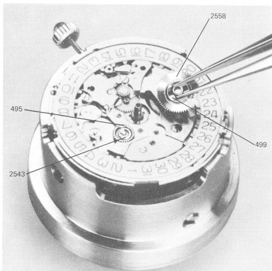
8.4.11 Introduire la pile neuve, signe+ dessus, en l'inclinant et en l'appuyant d'abord contre la bride positive, puis en appuyant dessus avec une pointe en plastique, la bride positive la maintenant en place de façon radiale.
